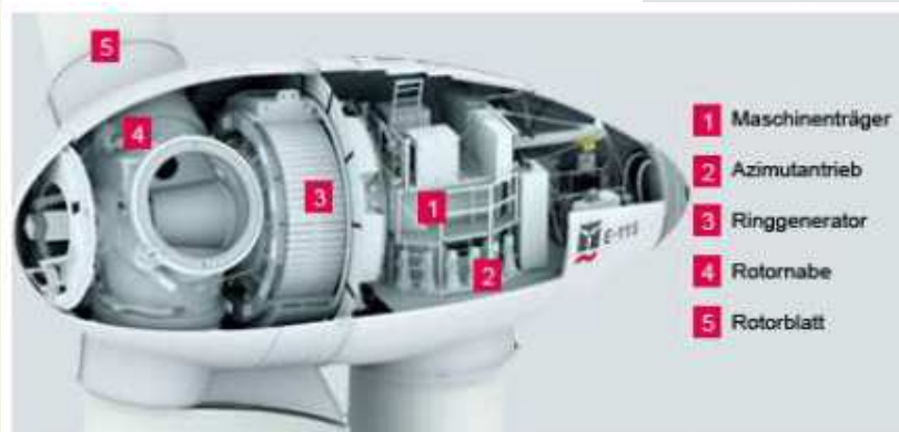
Gondelquerschnitt E-115 / 2.500 kW
